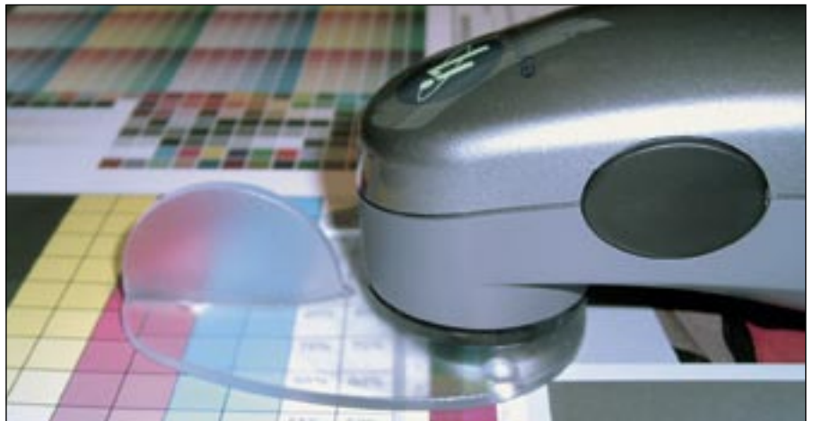
Die Vermessung von Testformen und Proofs mit einem Spectralphotometer gibt Auskunft, ob sie der Norm entsprechen und dient zur Qualitätssicherung und Rechtsverbindlichkeit.
