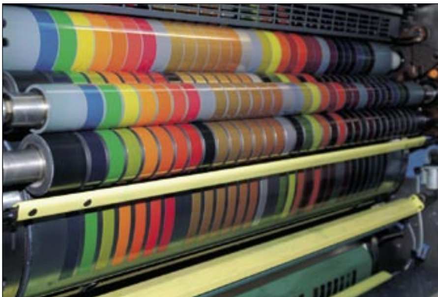
Durch die minimale seitliche Verreibung entsteht kein Irisdruck-Effekt: Die Farben kommen randscharf getrennt bis auf das Gummituch – und auf den Bogen.
