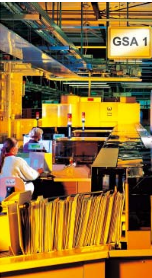
Beim Einkauf von Deutsche Post DHL hat sich die Kostenstrukturanalyse insbesondere beim Einkauf von Fahrzeugen und Produktionssystemen bewährt. Hier: automatische Großbriefsortieranlage in einem Briefzentrum der Deutschen Post
