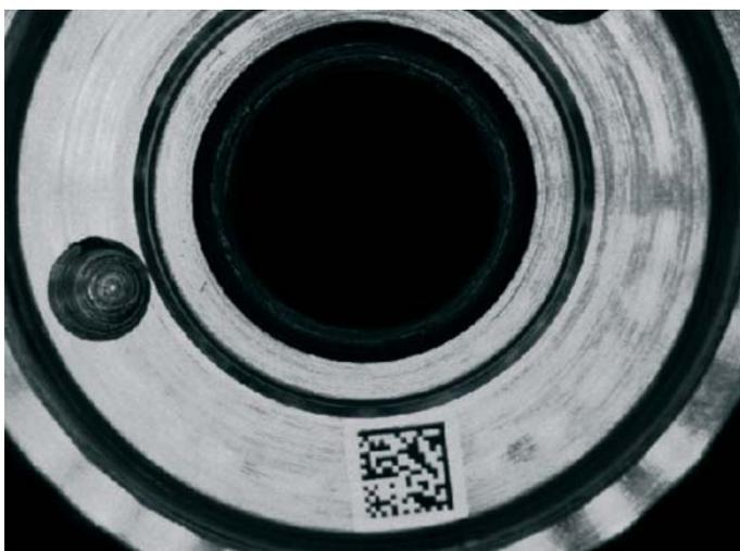
Bild 1: Ein auf dem Werkstück aufgedruckter Data Matrix Code (DMC)
